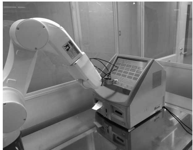
●図-2 タッチパネルの自動連打テストの様子●
