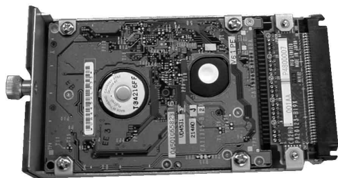
図 4 AR3000 シリーズ モデル 3100 HDD/CF 前面保守 ( Fig.4-HDD/CF front maintenance of AR3000 Series Model 3100 )
