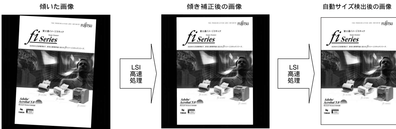
図 7 自動傾き補正，自動サイズ検出の図 ( Fig.7-Automatic orientation adjustment / automatic size detection )
